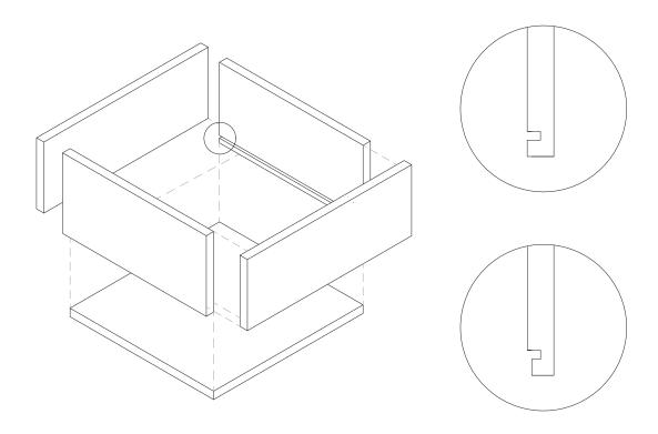
Para la colocación de las guías, según cual se utilice, se deberá realizar un ranurado en los laterales del cajón para su encastre junto al fondo.
